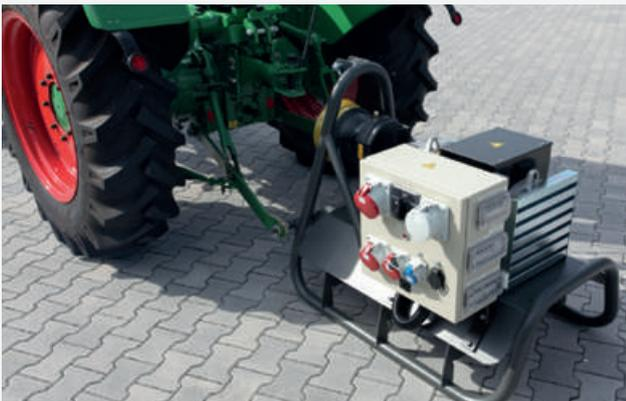
*Die Antriebsleistung in PS des Traktors muss ca. 2-3x der Generatorleistung entsprechen, z.B. bei einem 25KVA Zapfwellengenerator muss der Traktor min. 75PS haben. Die Überdimensionierung nicht zu knapp bemessen, damit die Spannungstabilität bei Belastungsschwankungen erhalten bleibt.*
